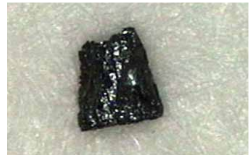
Abb. 33: Ferritpartikel, erkannt als Nichtmetall (558 µm)
