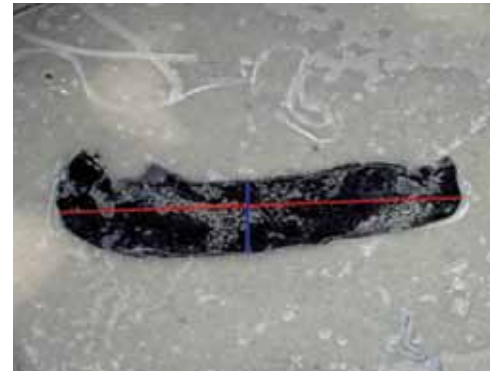
Abb. 71: Partikel von angelieferten Kunststoffelementen
