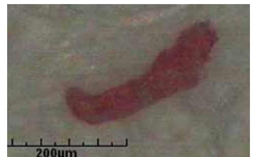
Abb. 35: Nichtmetallischer Partikel, vermutlich Verpackungsmaterial, rosa Schaumstoff'
