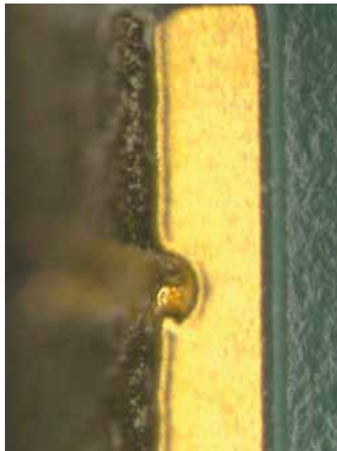
Abb. 61: Anbindungen für galvanische Vergoldung
