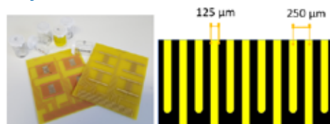
Abb. 90: SIR Testleiterplatten (Layout als verzahnte Kammstrukturen)
