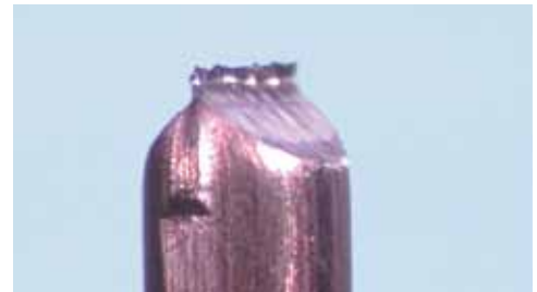
Abb. 23: Seitenschneider-Schnitt am Kupferdraht D = 2,25 mm, Gratbildung
