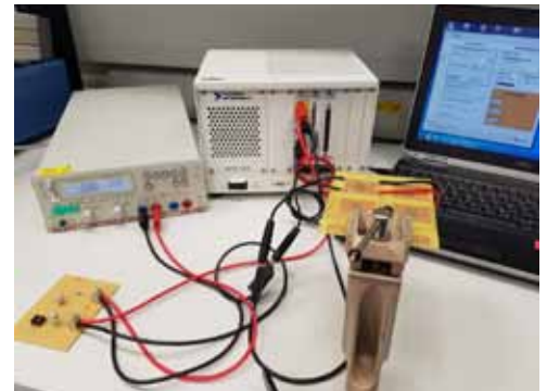
Abb. 92: Automatisierte softwaregestützte Strommessung
