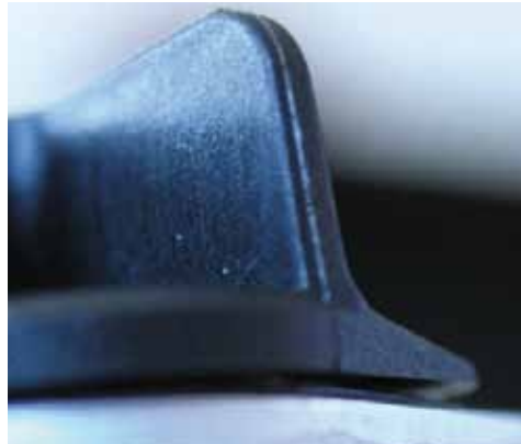
Abb. 70: Kunststoffelement mit Grat
