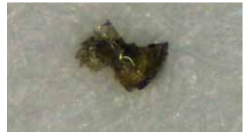
Abb. 35: Nichtmetallischer Partikel, vermutlich Verpackungsmaterial, rosa Schaumstoff'
