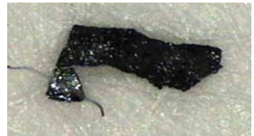
Abb. 34: Nichtmetallischer Partikel, vermutlich Grat oder Kunststoffrest (217 µm)
