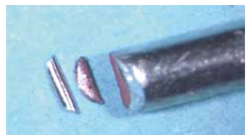
Abb. 24, 25: Abgefallene Partikel vom geschnittenen Draht D = 1,8 mm (Kupfer verzinkt)
