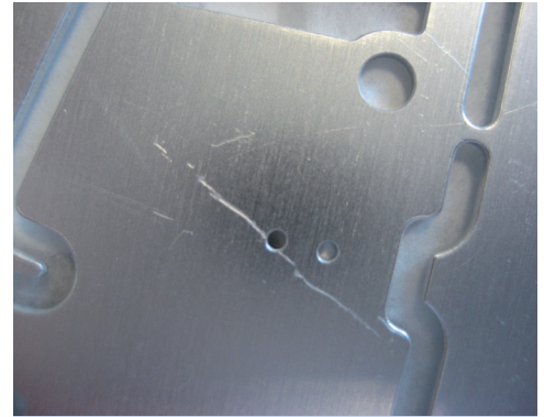
Abb. 67: Beschädigte metallische Versteifung
