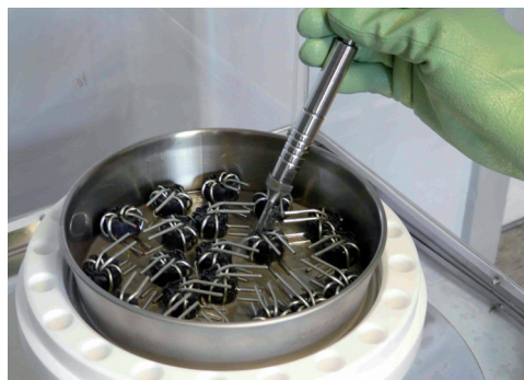
Abb. 3: Bauteilaufnahme beim manuellen Spritzen
