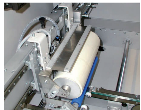
Abb. 86: Adhäsionsrolle für die Durchlaufreinigung von Leiterplatten
