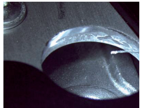
Abb. 69: Stanzreste durch Beizen gelöst
