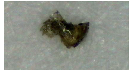
Abb. 35: Nichtmetallischer Partikel, vermutlich Verpackungsmaterial, rosa Schaumstoff'
