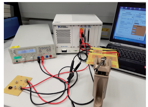
Abb. 92: Automatisierte softwaregestützte Strommessung
