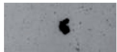
nichtmetallischer Partikel 261 \mu\text{m}
