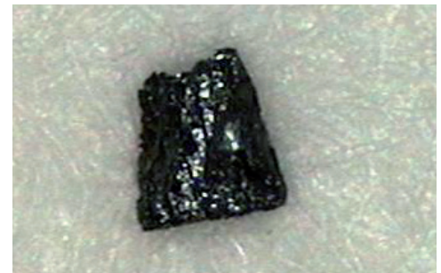
Abb. 33: Ferritpartikel, erkannt als Nichtmetall (558 µm)
