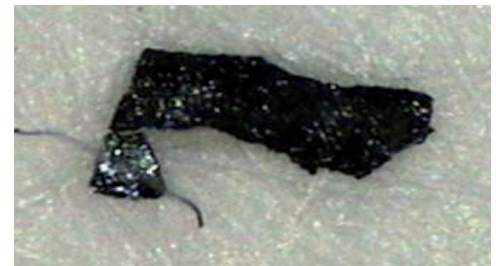
Abb. 34: Nichtmetallischer Partikel, vermutlich Grat oder Kunststoffrest (217 µm)
